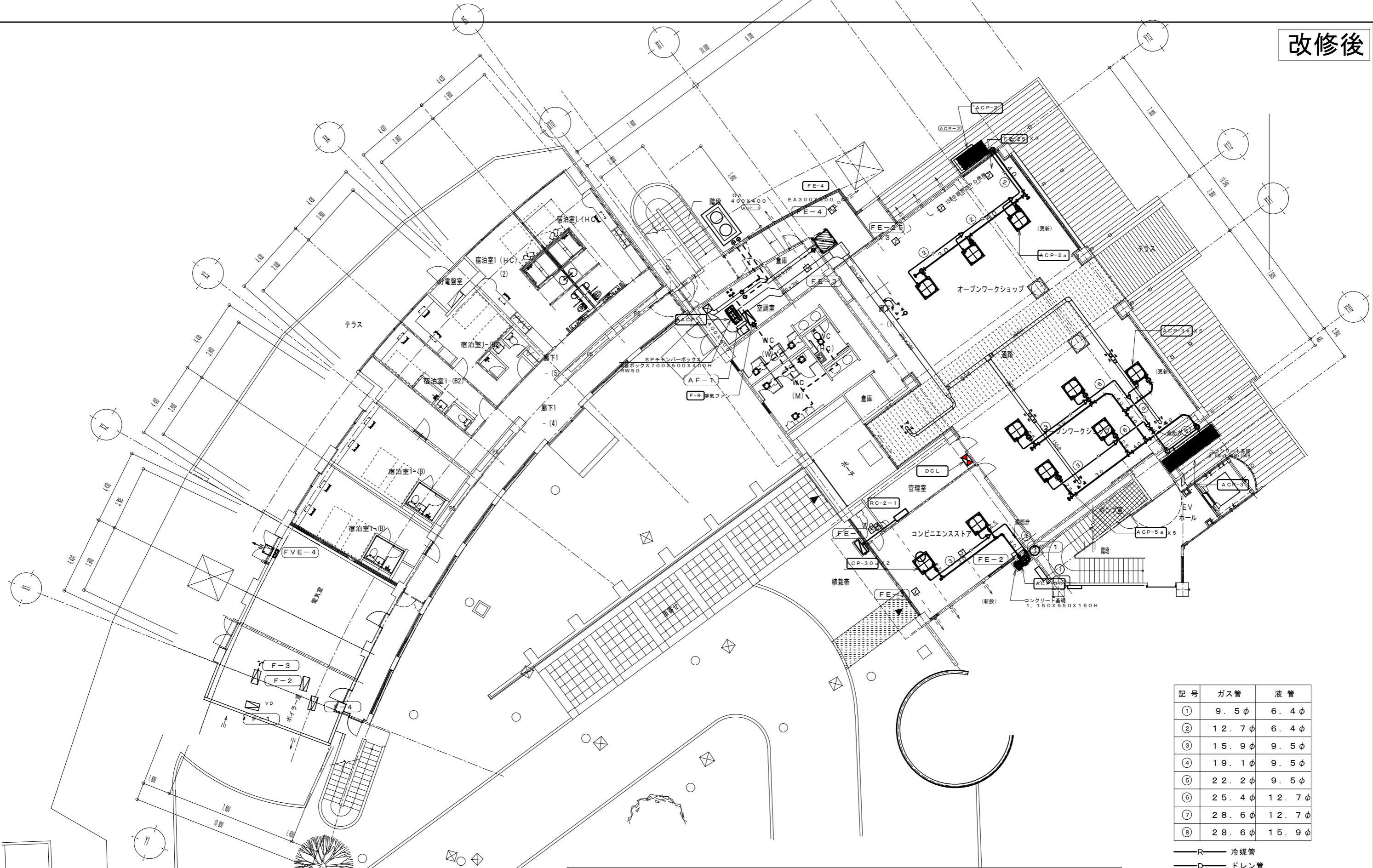
AB棟1階空調・換気設備平面図 A1 ; S=1/100 A3 ; S=1/200
