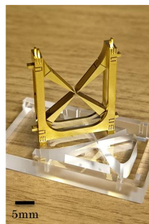
図 1. ガラス基板上に乗せた、金メッキを施した 3D プリント製のイオン・トラップ
